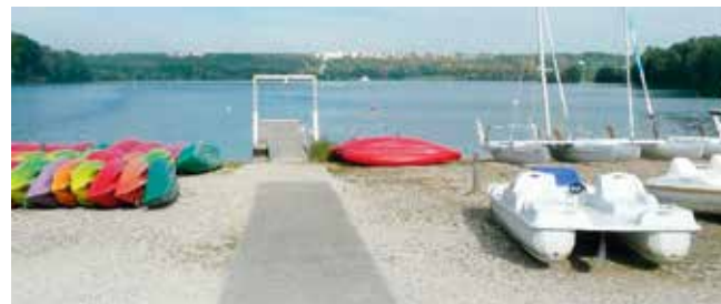
Illustration d'un cheminement accessible garantissant la circulation des fauteuils roulants jusqu'au ponton
