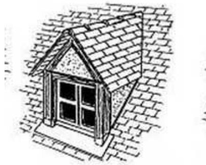
lucarne à deux pans dite jacobine, en bâtière ou à chevalet
